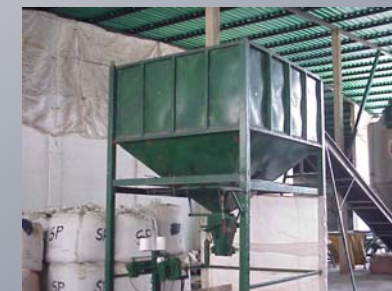
Tolva de Ensacado.
