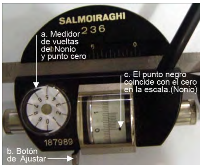
Figura 3. Equipo medidor y ajustador del planímetro.
