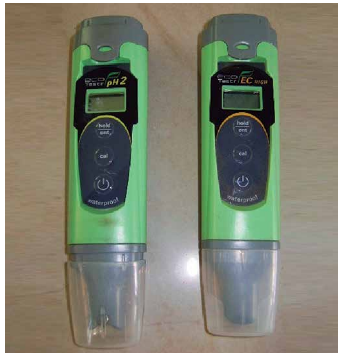
Foto 1. Potenciómetro y Conductímetro de campo para la determinación de pH y conductividad eléctrica.
