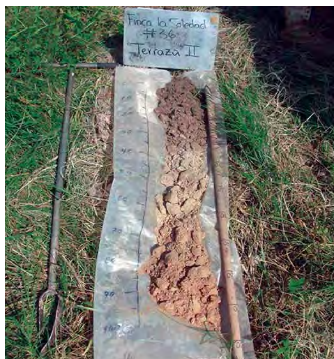
Foto 2. Perfil de suelo hasta 1 metros de profundidad para realizar descripción de horizontes pedogenéticos.
