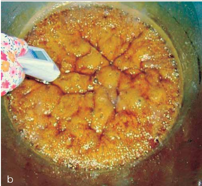
Foto 7 a) Termocupla. b) Medición de temperatura con Termocupla.
