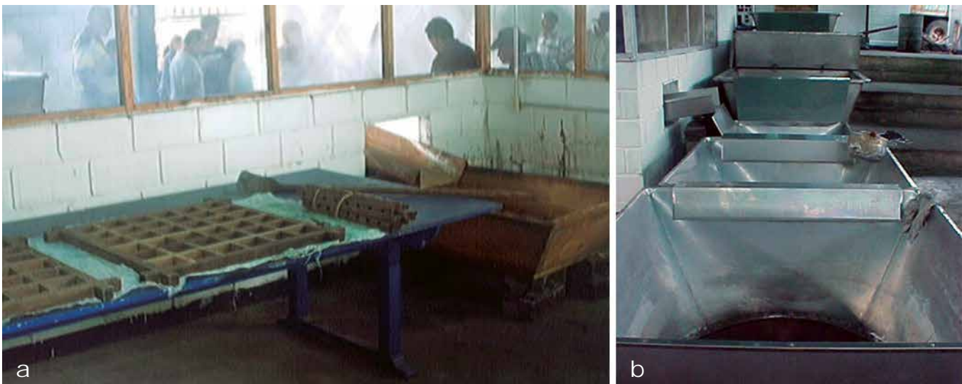
Foto 6. a) Sala de batido y moldeo de central de beneficio de café; b) vista de tren de pailas.
