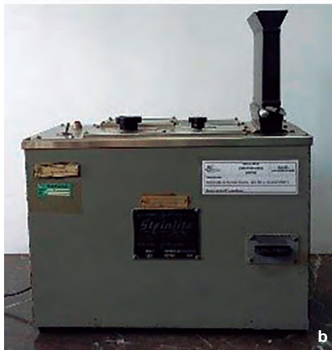
Foto 7. Determinadores de contenido de humedad. a) Estufa y b) Steinlite.
