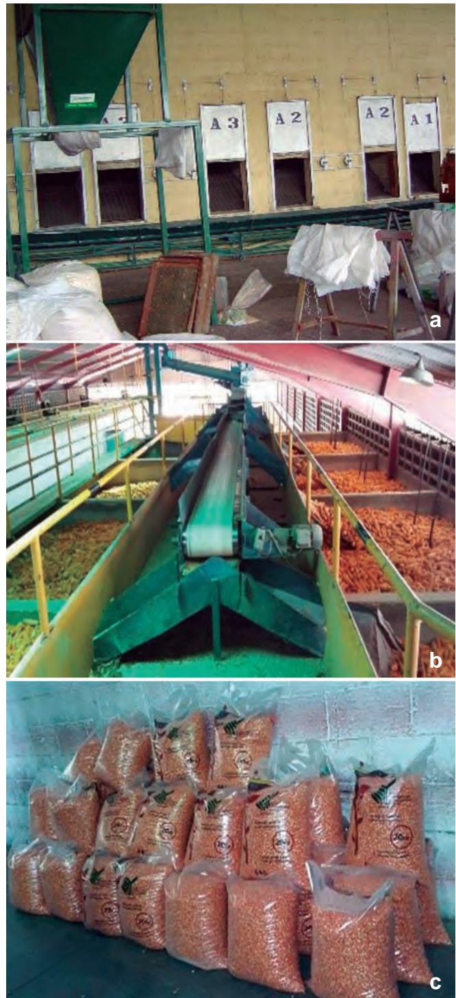
Foto 1. Secado artificial de semilla de maíz en mazorca: a) Cuartos de secado, b) Maíz dirigido hacia cuartos de secado y c) Maíz envasado listo para lotificar.
