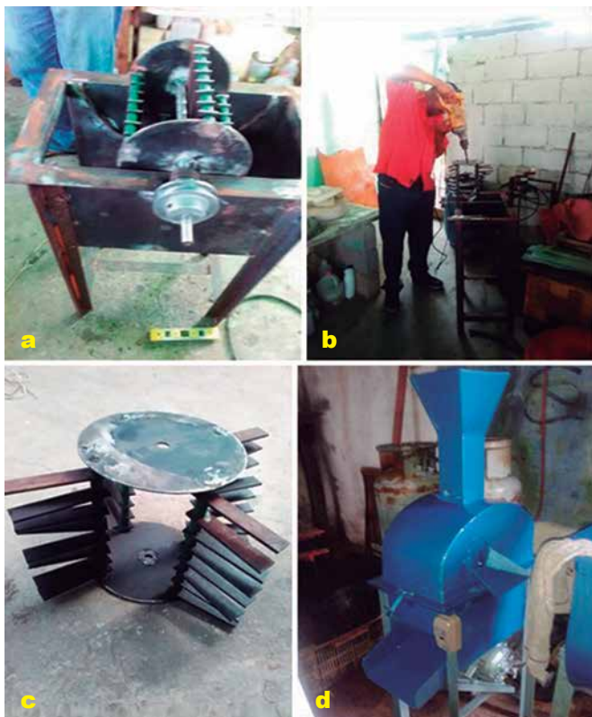
Foto 3 a, b, c y d. Construcción de molino martillo y cuchillas.
