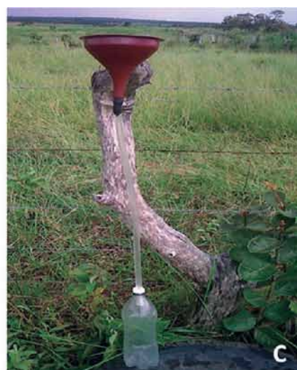
Fotos a. Productor agrícola instalando el pluviómetro en el sector Yopales; b. Inducción a productora agrícola en el sector La Leona; c. pluviómetro alternativo instalado en una finca ubicada en el sector Bare 11 de Anzoátegui.
