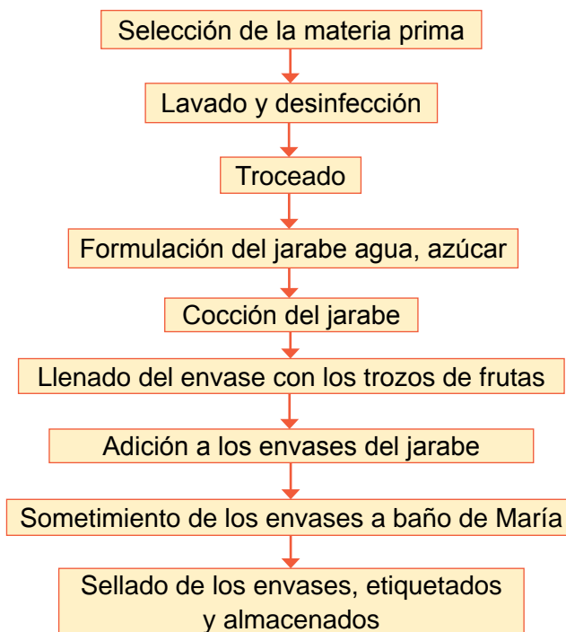
Figura 3. Esquema tecnológico para la elaboración de tamarindo estrella en almíbar.
