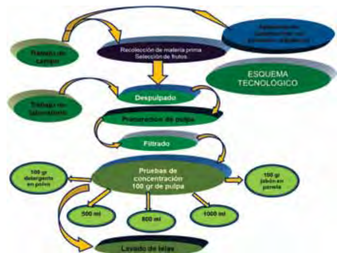
Figura 1. Esquema del proceso de recolección de muestra y trabajo de laboratorio.
