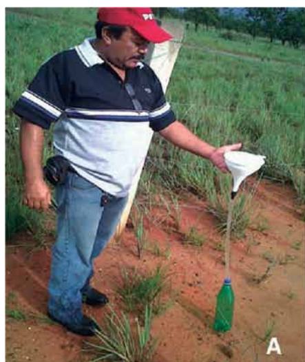
Fotos a. Productor agrícola instalando el pluviómetro en el sector Yopales; b. Inducción a productora agrícola en el sector La Leona; c. pluviómetro alternativo instalado en una finca ubicada en el sector Bare 11 de Anzoátegui.
