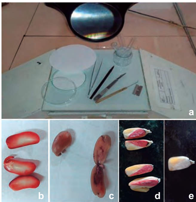
Foto 10. Ensayo de Viabilidad con Tetrazolio.
