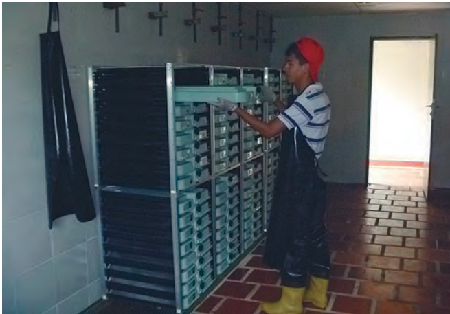
Foto 6. Incubadoras verticales tipo heath.
