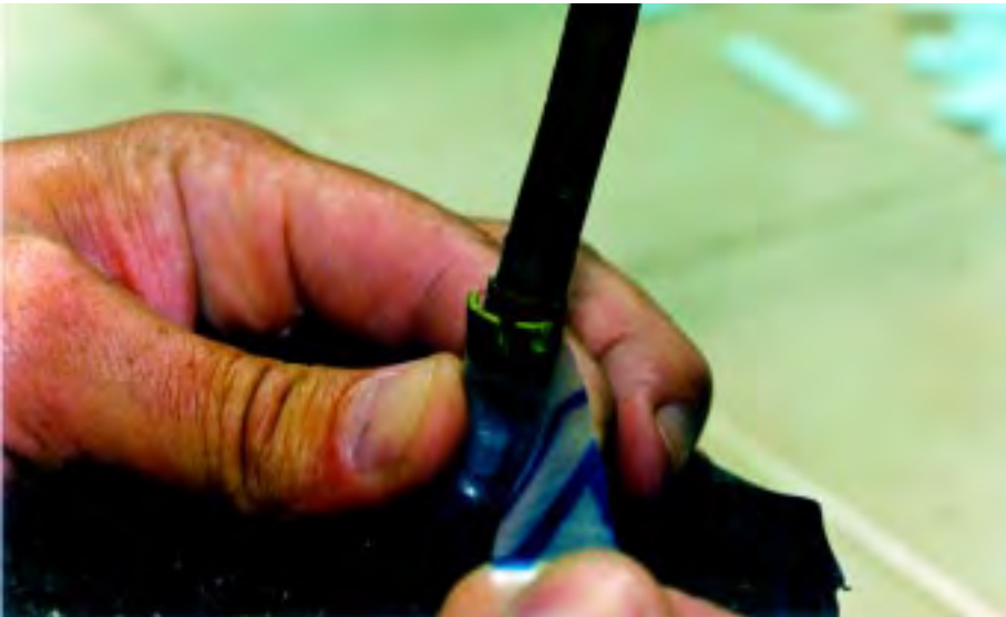
Figura 16. Amarre del parche al patrón de abajo hacia arriba, con cinta inflexible.
