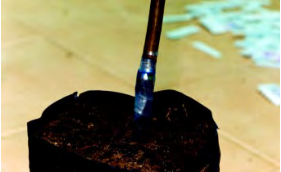
Figura 17. Amarre completo del parche al patrón, con la cinta inflexible.
